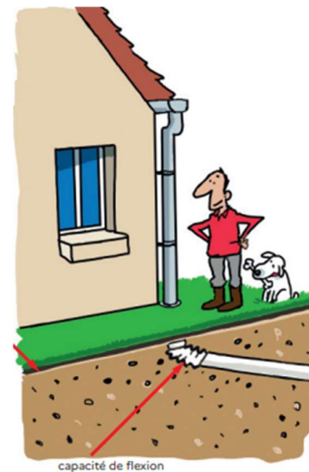
FIGURE 27 : CAPACITE DE FLEXION ( SOLS ARGILEUX, SECHERESSE ET CONSTRUCTION | MINISTERES ÉCOLOGIE ÉNERGIE TERRITOIRES (ECOLOGIE.GOUV.FR) )
