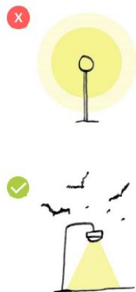
Fig.8 - Adaptation de l'éclairage
